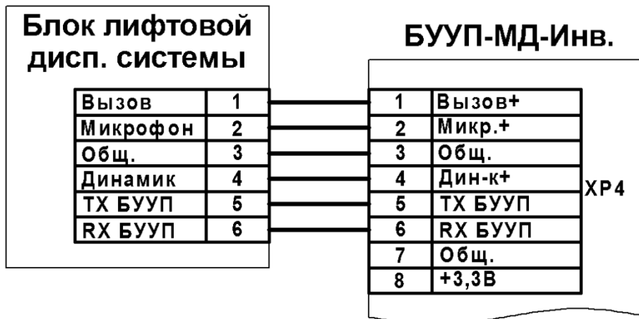
Рисунок 2.1 – Схема подключения к разъему XP4
